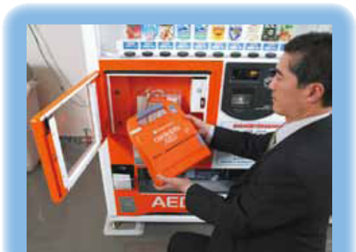
心臓の病気で倒れた人の命を救うための装置 (AED) を備えた自販機。
